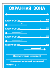
Закрепление трассы газопровода на местности 450x600 мм
