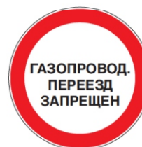
Газопровод. Переезд запрещен D – 600 мм
